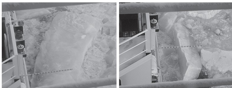
Рис. 2. Примеры характерных измерений многолетнего льда толщиной 330 см (слева) и однолетнего льда толщиной 120 см (справа) (общая длина измерительной рейки – 350 см, одного деления – 10 см)
